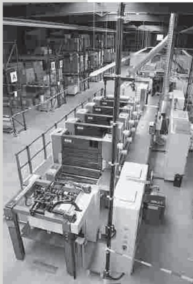
Neueste Errungenschaft des Industriebetriebes Offermann ist eine Fünf-Farben Druckmaschine mit Lackturm.
